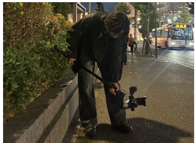
図 2. ジンバルに一脚を接続し撮影
